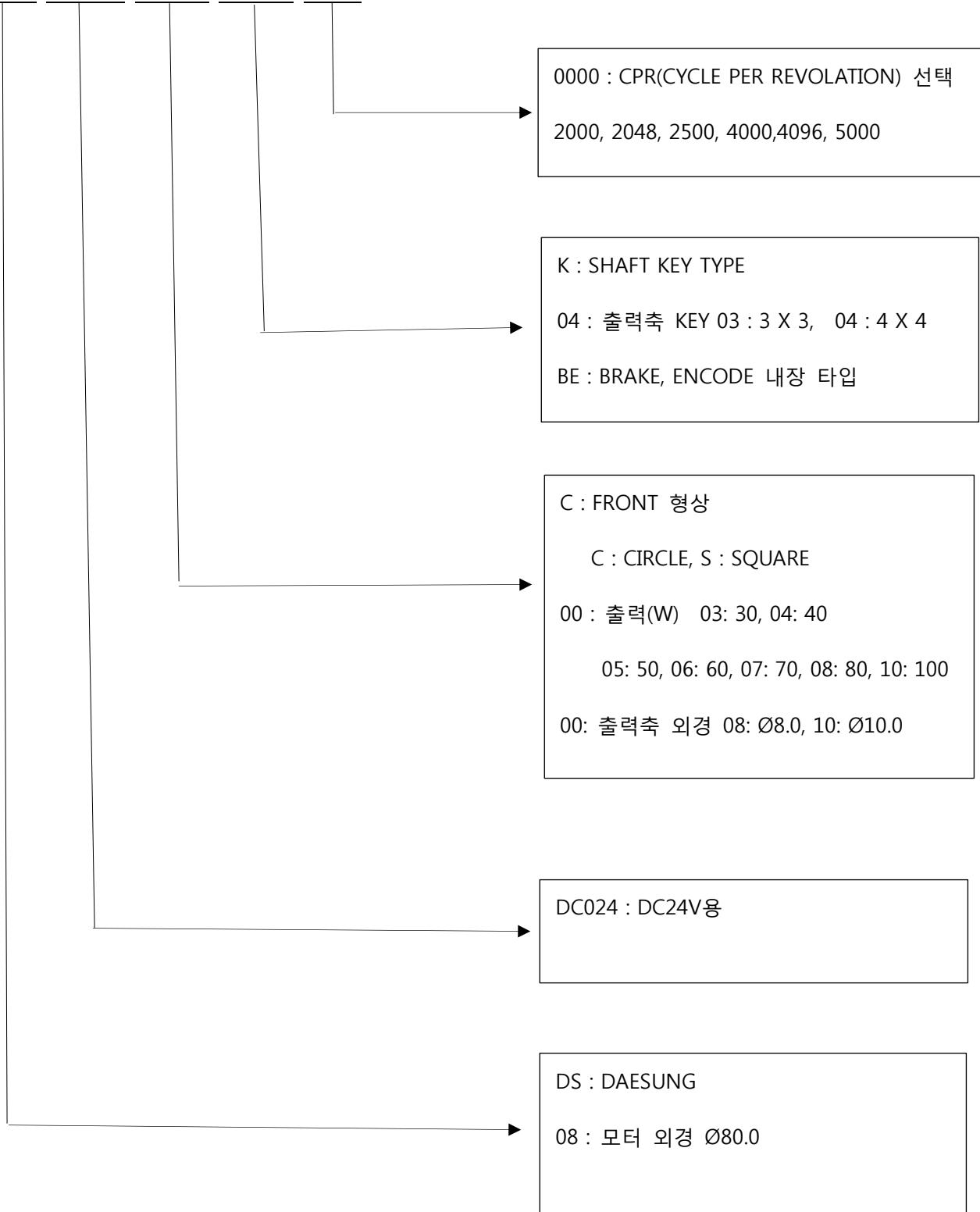
MOTOR의 용량이 70W 이하는 출력축 Ø8.0(KEY 3 X 3)이고, 80W 이상은 출력축 Ø10.0(KEY 4 X4)이다.
